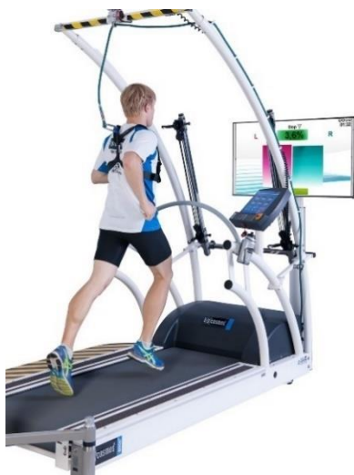
Figure 7 : Tapis roulant motorisé avec plateforme sensible à la pression
