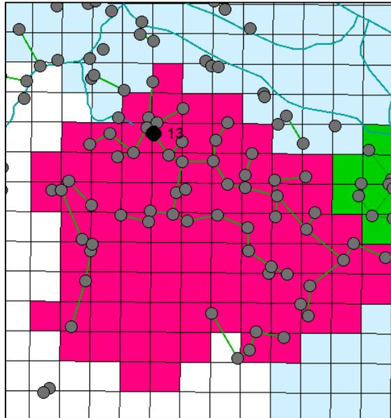
Figure 14 : Bassin versant issu de l'exutoire n°13. Les arcs verts sont les arcs d'eaux pluviales reconstruits grâce à TOHR, le nœud noir correspond à l'exutoire n°13. Les mailles roses correspondent au bassin versant
