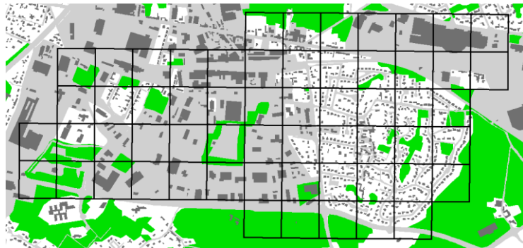
Figure 15 : Occupation du sol du bassin versant n°3. Les surfaces vertes correspondent à la végétation, les surfaces grises foncées au bâti et les surfaces grises claires à la voirie.
