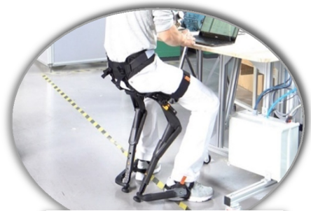
Figure 5 : Chairless Chair ® par Gobio-Robot (Source Noonee)
