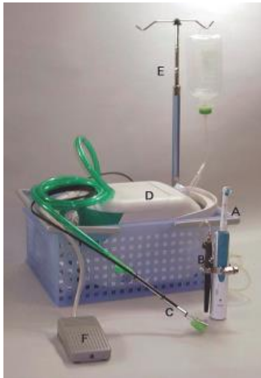
Figure 10 : Vue d'ensemble du dispositif d'aide au brossage bucco-dentaire
