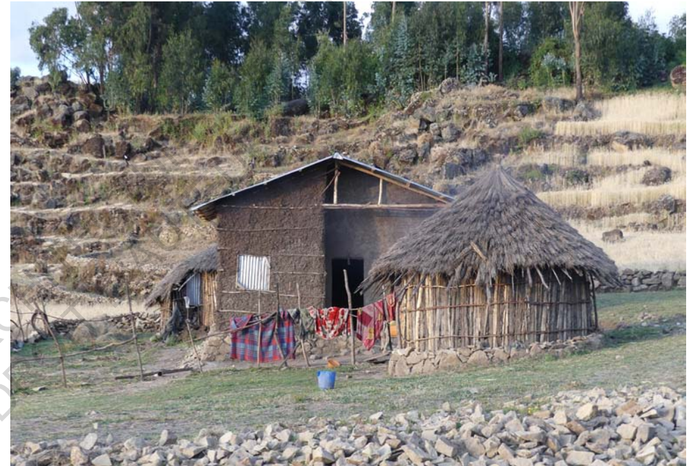
Habitation rurale auto-construite, en bois, terre, tôle ondulée et chaume. Lalibela.
