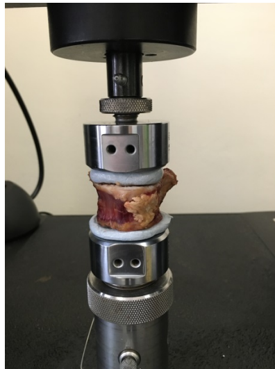
Fig 1 : Machine d'essai de compression avec échantillon vertébral.
