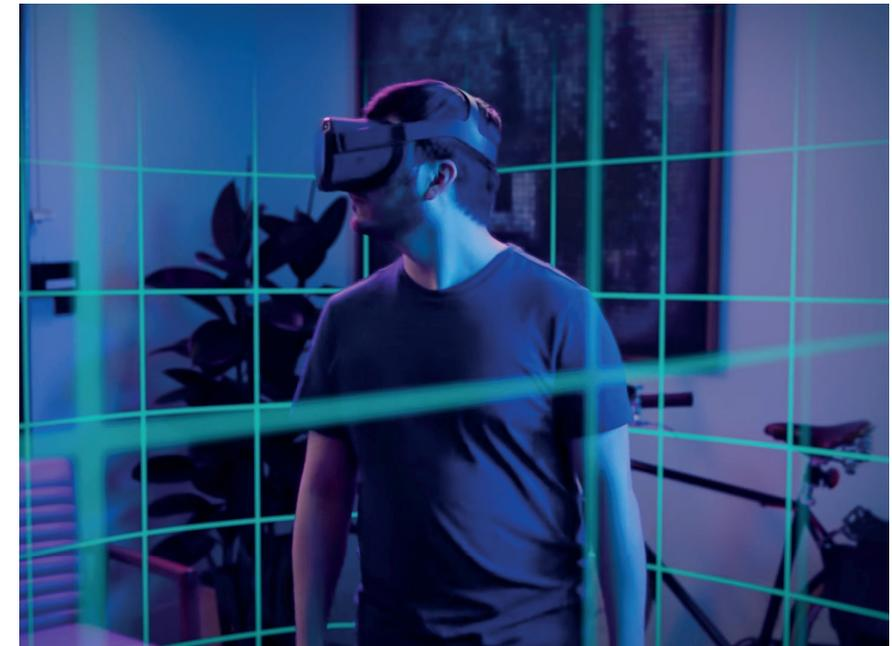
FIGURE 85: Un système de maillage projeté en immersion permet de voir la limite de l'espace de jeu. **Oculus Guardian System**. Oculus VR.
