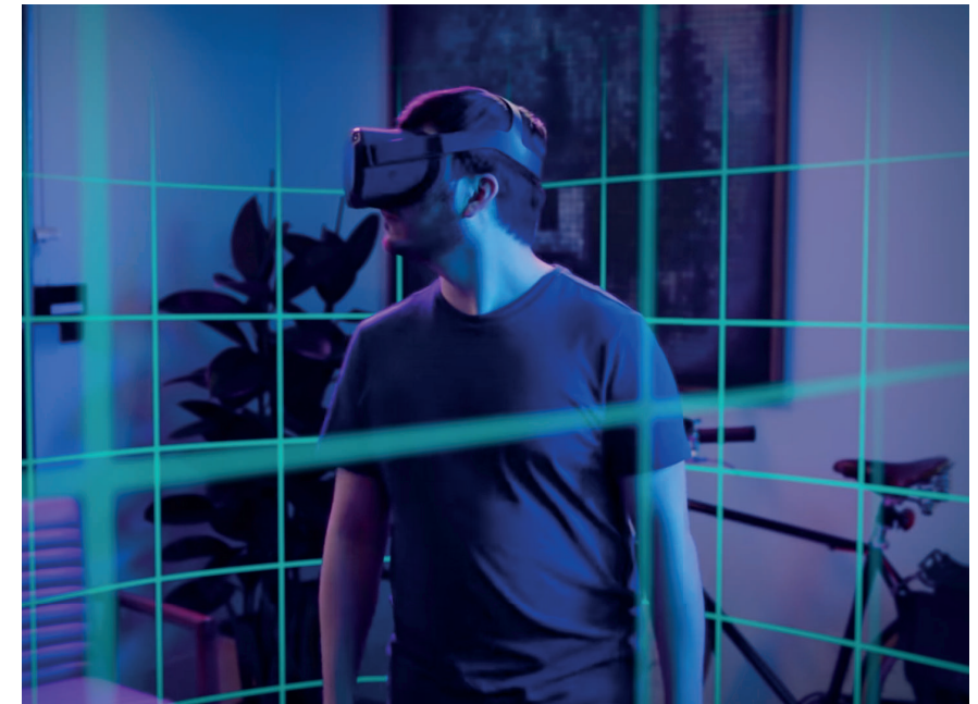
FIGURE 85: Un système de maillage projeté en immersion permet de voir la limite de l'espace de jeu. Oculus Guardian System . Oculus VR.
