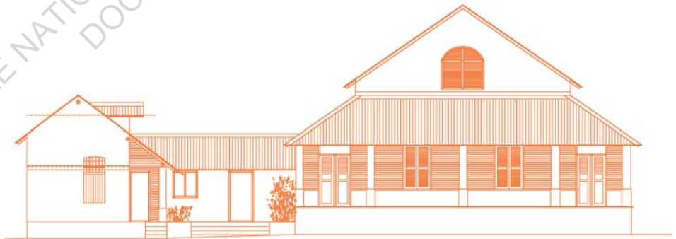
Façade du projet de réhabilitation d'une maison de la pénitentiaire, réalisé en 2015. A l'exception de l'ajout d'un étage en partie supérieure et donc de lucarnes, l'aspect général de la maison est conservé ©Production personnelle
