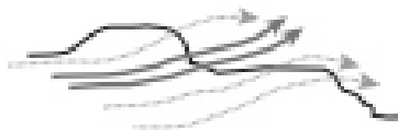
Les vents qui sont déviés et canalisés ont une vitesse d'air accrue au point de passage le plus étroit. C'est l'effet Venturi
