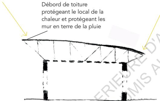
**Figure 103: Système de protection solaire et pluviale**
