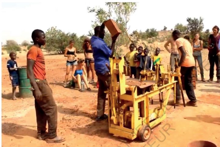
Figure 105: Expérimentation du BTC avec une presse
