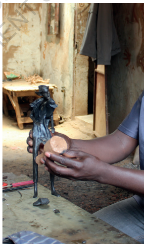
Figure 18: Réalisation d'une statue de bronze à la cire perdue
