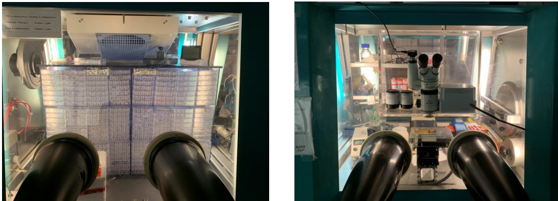
Figure 17 : Boite à gant pour la cristallisation des protéines
