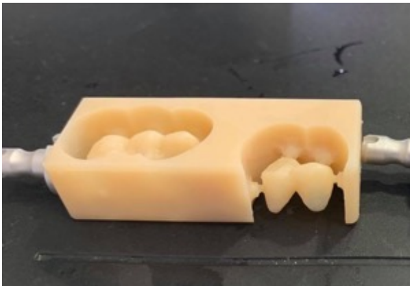
f) Usinage des restaurations provisoires dans un bloc de résine Telio CAD
