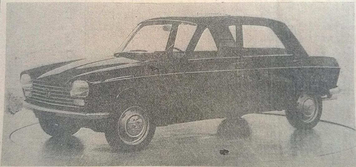
**LA « 204 », 6 CV, 4 places, 4 portes, encombrement minimum (moins de 4 m. de longueur totale). Traction avant à moteur transversal en aluminium coulé sous pression, arbre à cames en tête, vitesse : plus de 130 km/h., 8 litres aux 100 km, poids 800 kgs environ. Présentation : printemps 1965.**
