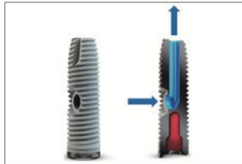
Figure 3: Schéma du fonctionnement de l'implant du système iRaise®<sup>38</sup>
