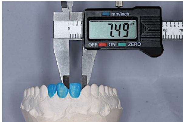
Figure 46: Compas digital pour vérifier la correspondance des dimensions entre le wax-up numérique et le wax-up en cire (Pimentel et al. 2016).
