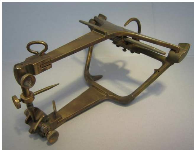
Figure 30 : Articulateur SIMPLEX de A. GYSI (1917) distance intercondylienne : 101mm
