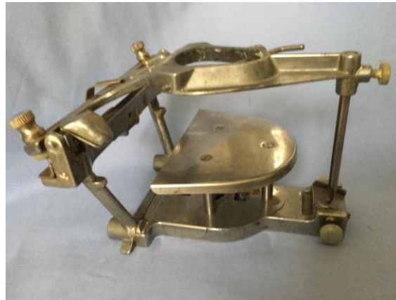
Figure 31 : Articulateur NEW SIMPLEX de A. GYSI (1960) distance intercondylienne : 108 mm
