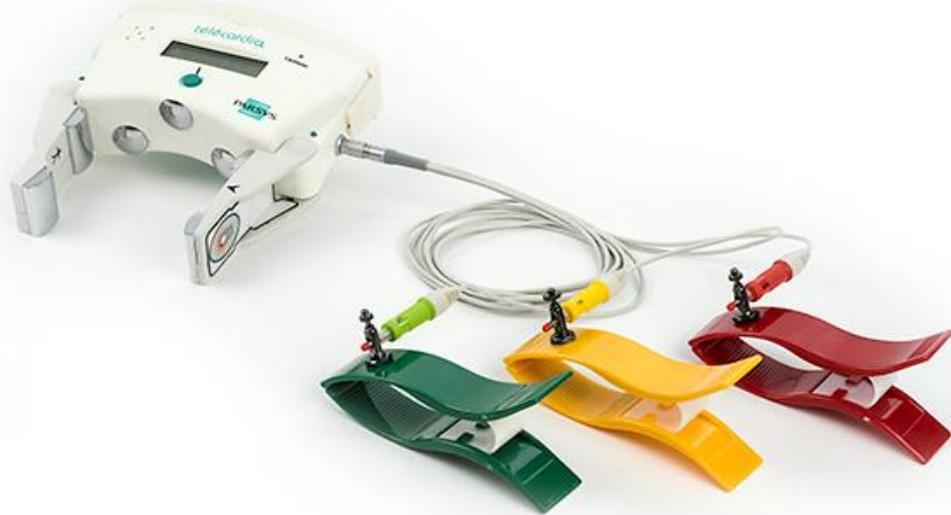
Télécardia, appareil fabriqué par Parsys, est un électrocardiographe 12 dérivation, portable, compact et léger, à électrodes thoraciques fixes, sans consommable. L'acquisition du tracé ECG se fait en 15 secondes et il est transmis automatiquement par Bluetooth à une station mobile.
