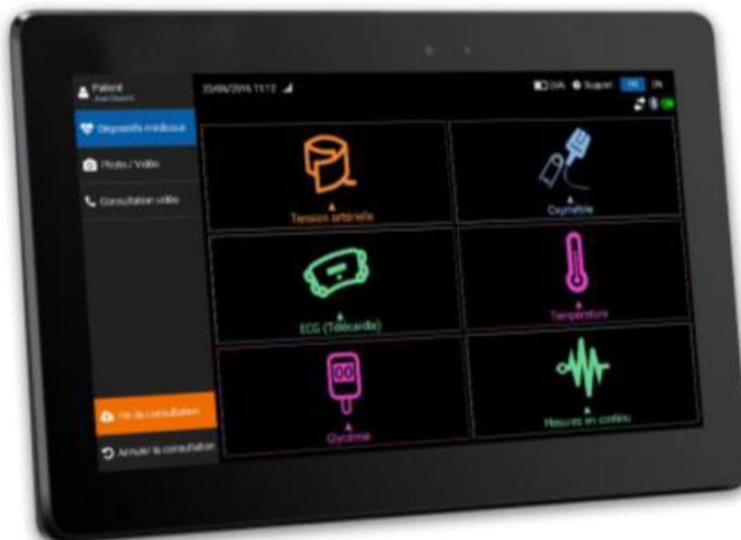
La tablette PC tactile est une tablette dotée d'un écran tactile de 10,1 pouces et d'un hub de 4 ports USB. Elle permet la saisie des données du patient lors de chaque consultation et les données recueillies par les capteurs apparaissent automatiquement à l'écran.
