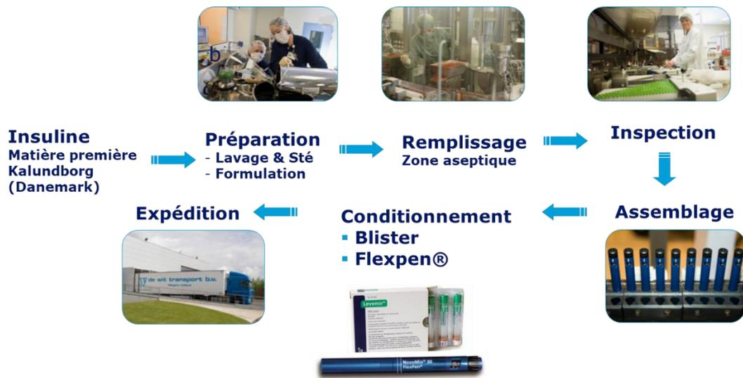
Figure 7 Process de production au sein du site Novo Nordisk® de Chartres
