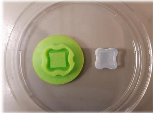
*Sur la gauche on observe le moule permettant de faire la plaque d'agarose avec 256 micro-puits présent sur la droite*
