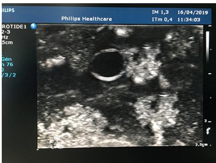
Figure 3 : Rendu échographie des phantoms de bras réalisés pour les formations à base d'agar-agar 5% avec ajout de farine.
