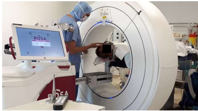
Figure 6: Robot Rosa, O-Arm et cadre de Leksell mis en place
