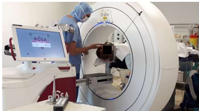
Figure 6: Robot Rosa, O-Arm et cadre de Leksell mis en place
