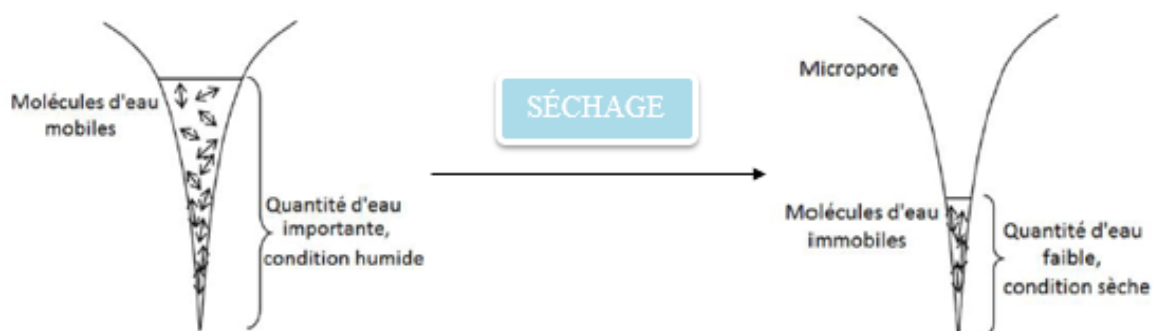
Figure 14 : Impact du séchage sur l'eau contenue dans les pores d'un granulé, (26)
