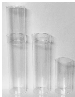
Figure 24 : Tube d'analyse en Styrolux® 656C - entier (gauche), partie inférieure (milieu) & partie supérieure (droite)
