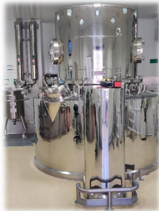
Figure 21 : Mélangeur - Granulateur - Sécheur de 2000 L
