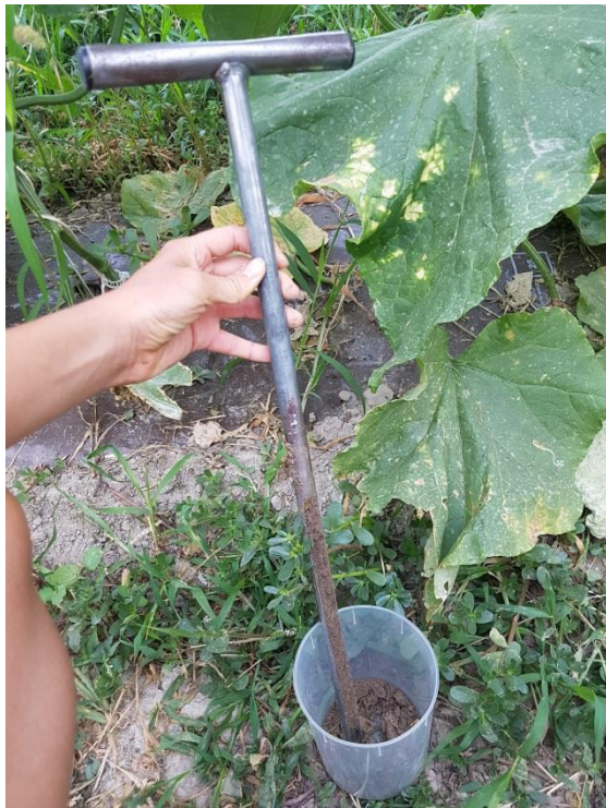
Figure 19 : Prélèvement de sol à la sonde 0-25cm
