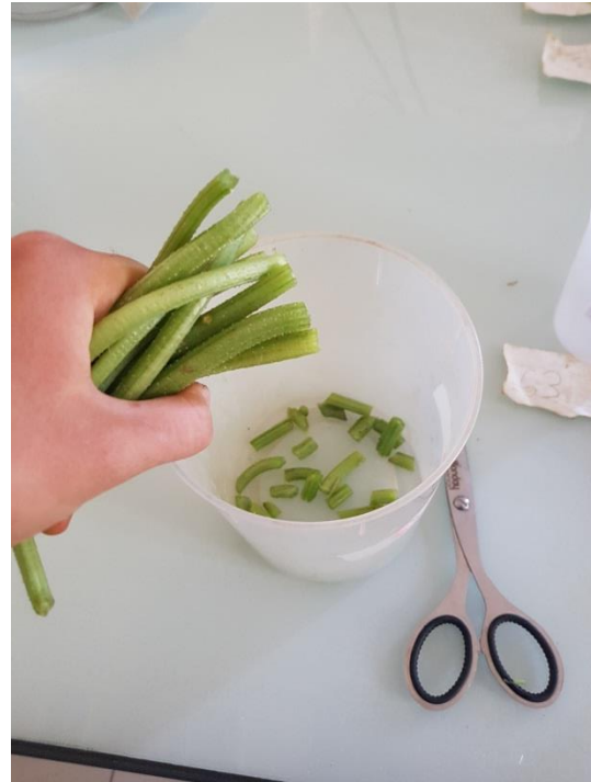
Figure 20 : Photo du découpage et de l'extraction de la sève de pétiole de concombre dans le cadre du protocole PILazo
