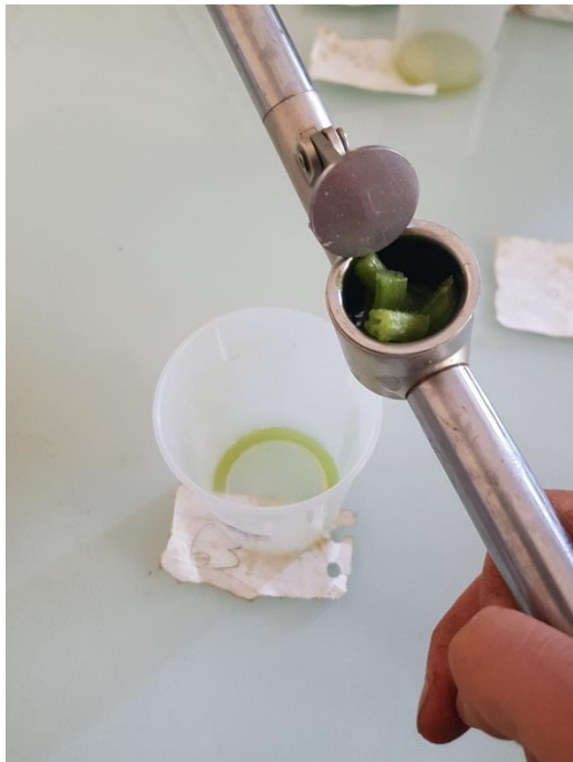
Figure 20 : Photo du découpage et de l'extraction de la sève de pétiole de concombre dans le cadre du protocole PILazo
