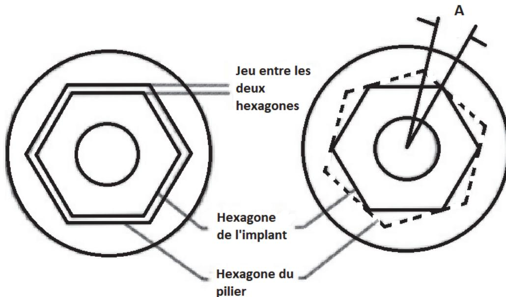
*Figure 3 : Schématisation du jeu en rotation présent entre l'hexagone du pilier et celui de l'implant. Ce jeu se mesure en degrés (8).*
