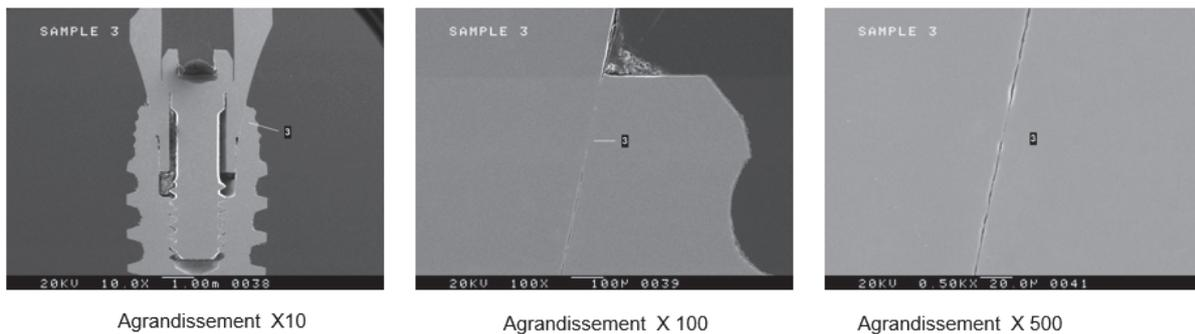
*Figure 5 : Coupes verticales d'une connexion interne conique sur l'implant Nobel Active de Nobel Biocare®. Lors de l'agrandissement au microscope, le microgap présent entre le composant prothétique et l'implant est visible.*
