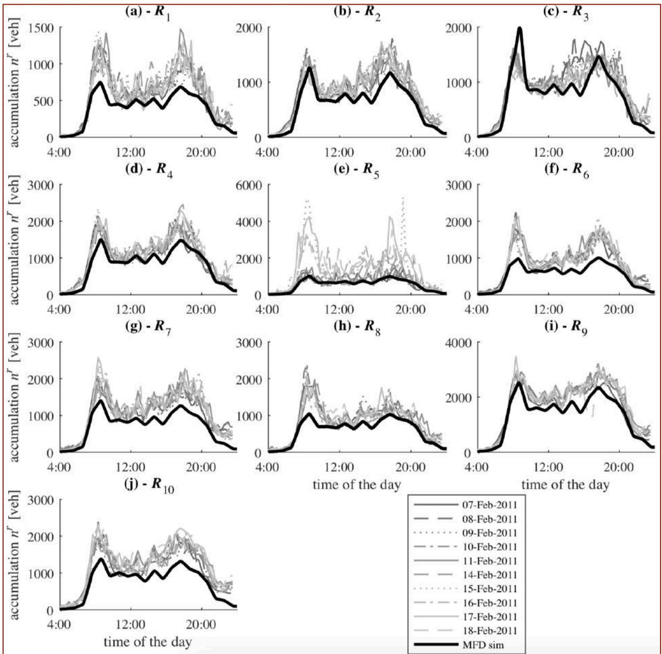
**Annexe 4 : Evolution de l'accumulation (en véh) par réservoir pour un découpage en 10 réservoirs avec les données du simulateur MFD 2011 (en gris) et les données du simulateur 2018 (en rouge)**
