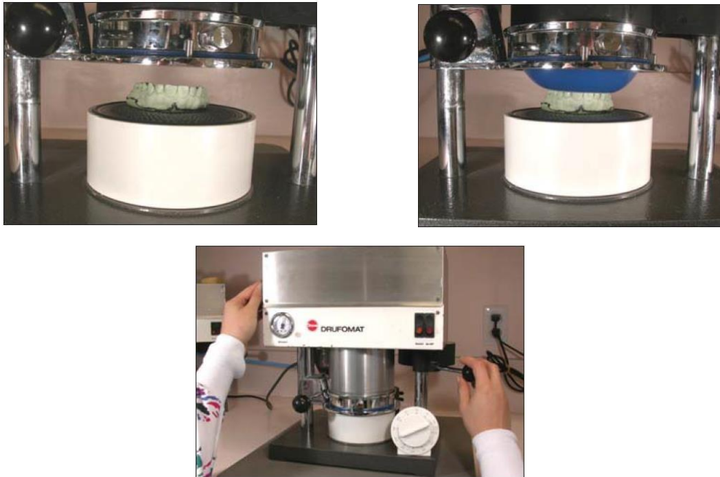
Figure 9 : Mise en place du modèle, ramollissement du matériau, abaissement du levier et mise en marche de la pression (machine DRUFOMAT)
