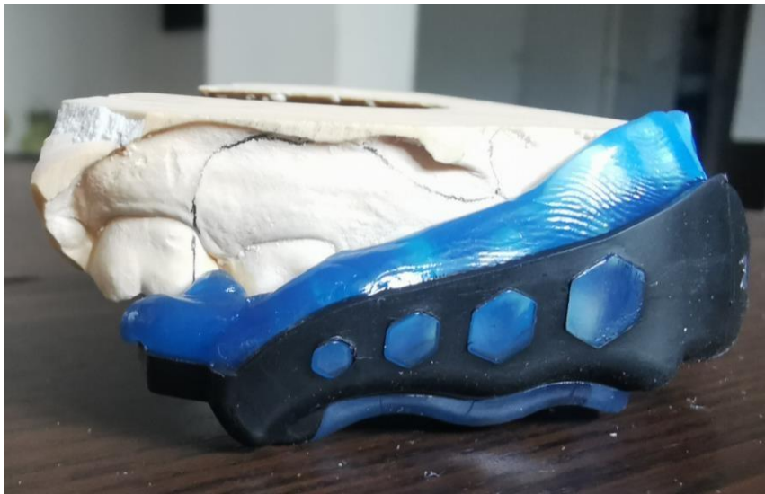
Figure 35 : Deuxième exemple : un protège-dents de type II Gel Max® de chez Shock Doctor® après 4 thermoformages
