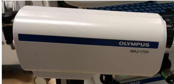
photo 3: transducteur reliant la mini sonde à l'écran
