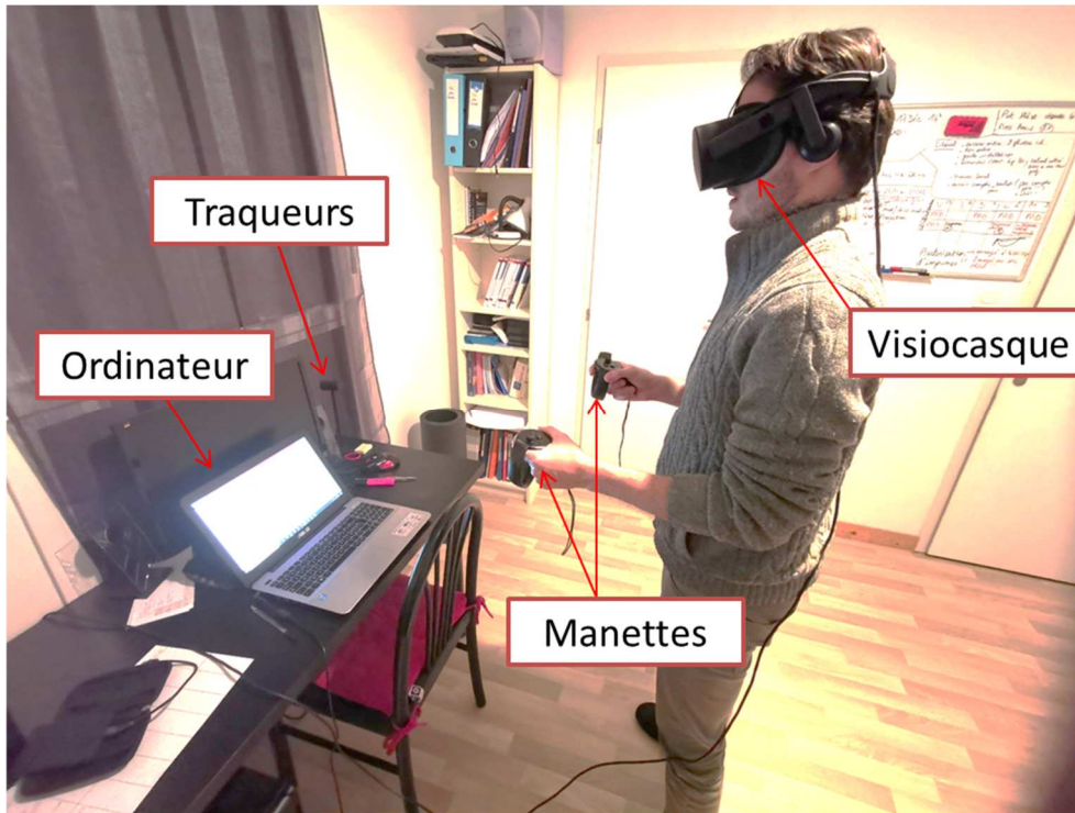
Figure 1 : Matériel de RV immersive commercialisé pour le grand public (Casque Oculus Rift®).
