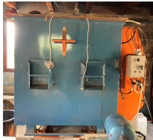
Figure 18 : séchoir à air pulsé, fonctionnant au gaz. (Ficaja, 1/07/2020) © Doria Bellache.
