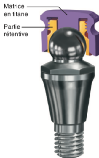
Figure 9: Système d'attache de type boule (D'après Baixe et al. (34))
