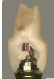
Figure 16: Photographie montrant une fracture d'un pilier implantaire (D'après Truninger et al. (58))
