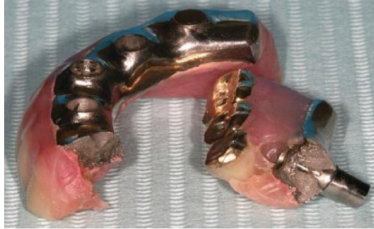
Figure 17: Fracture de l'armature d'une prothèse complète mandibulaire sur implants (D'après Drago et al. (63))
