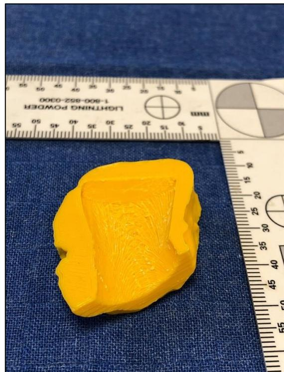
Figure 41 : Rugosité après dépose des supports– Crédit photo
