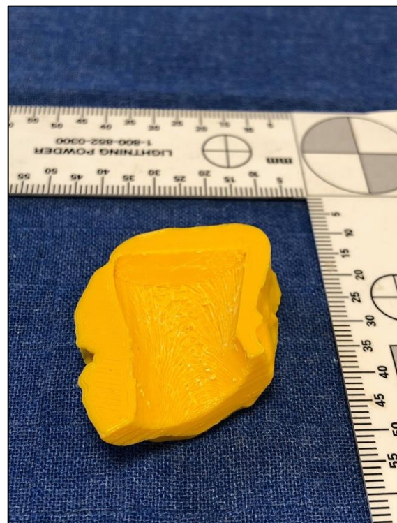
Figure 41 : Rugosité après dépose des supports– Crédit photo BOUSCAILLOU Camille
