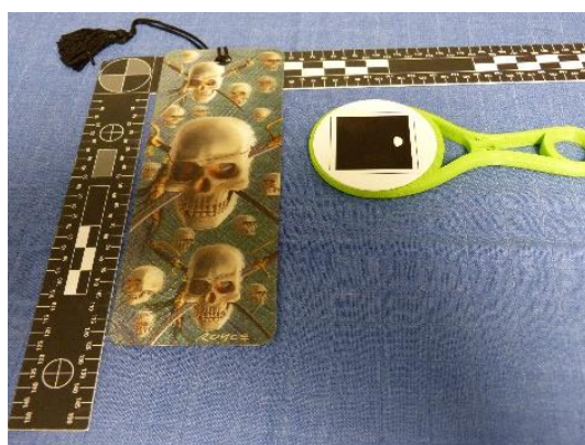
Figure X8 : petite gomme, on remarque des déformations au niveau des limites support/objet, il est difficile d'observer les détails de l'objet. (source Juliette Graziana)
