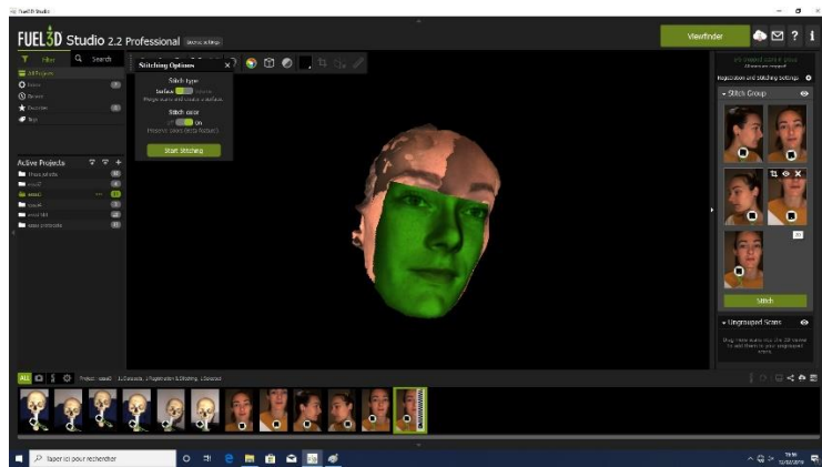
Figure 16: a) et b) Alignement des acquisitions après détournage du Visage J c) Résultat après alignement de toutes les acquisitions détournées (source Juliette Graziana)
