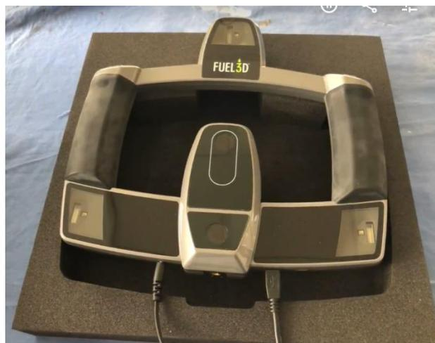
*Figure 10: Scanner 3D portable Scanify par Fuel 3D (source Juliette Graziana)*
