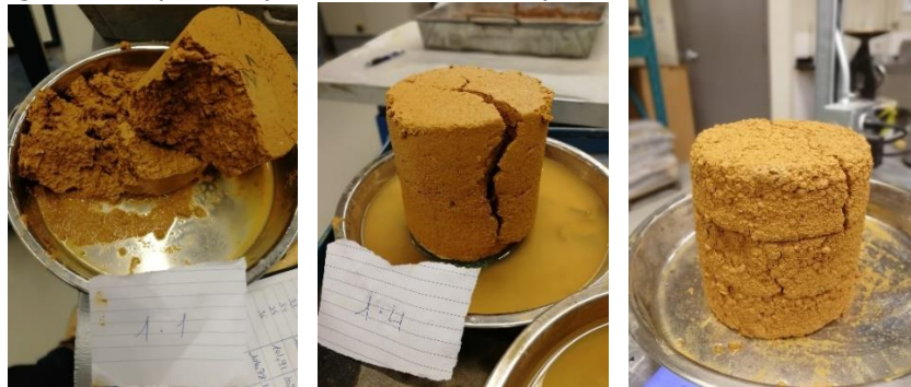
Figure 69 : Endommagement de quelques échantillons non-stabilisés
