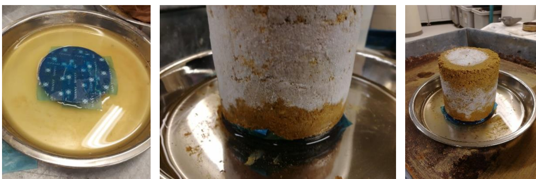
Figure 50 : Mise en place du dispositif d'absorption d'eau liquide lors du dégel
