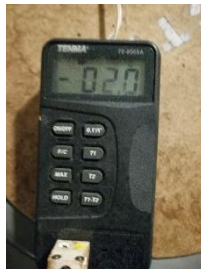
Figure 63 : Température du congélateur bloquée à -2°C en raison d'un problème de refroidissement pendant 3 jours consécutifs
