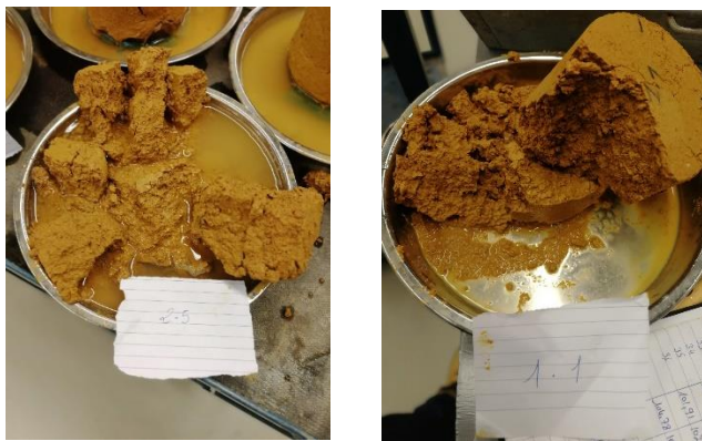
Figure 86 : Effondrement des échantillons à la suite de la période de dégel
