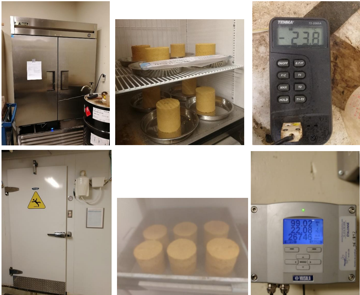
Figure 48 : Dispositif de gel dans le congélateur (en haut) et de dégel dans la chambre humide (en bas)
