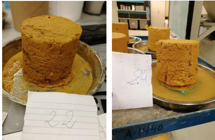
Figure 88 : Effondrements d'échantillons par perte de stabilité (saturation)
