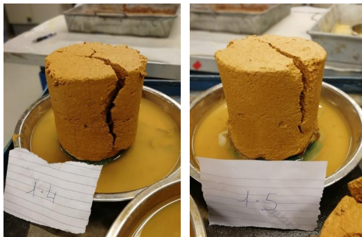
Figure 87 : Effondrements d'échantillons par ouverture de fissurations verticales
