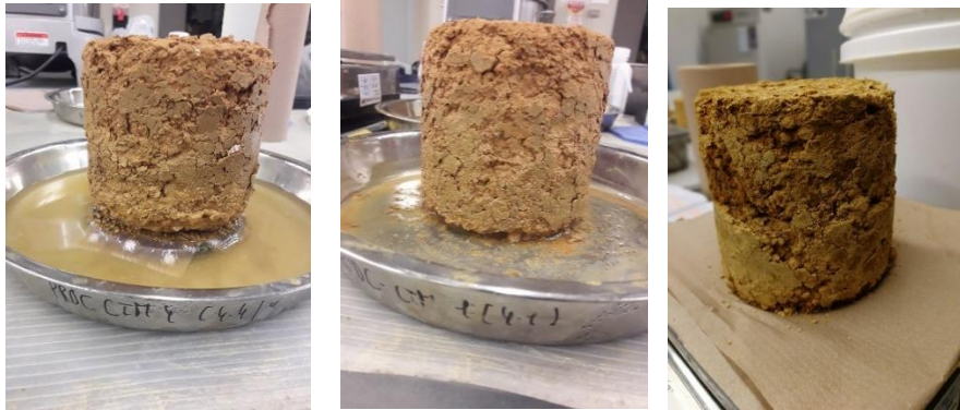
Figure 71 : Important écaillage d'échantillons stabilisés après plusieurs cycles de gel-dégel
