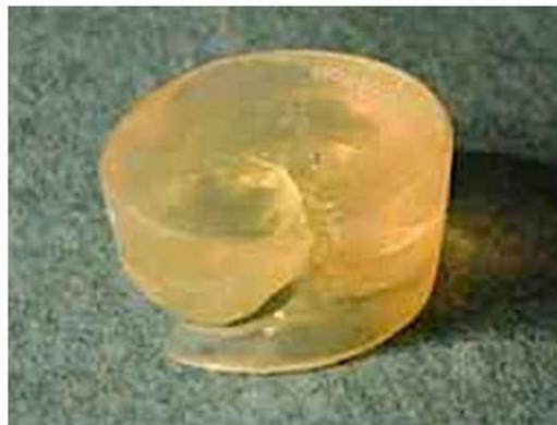
**Figure 11** Fracture d'un implant de Swanson [6]
