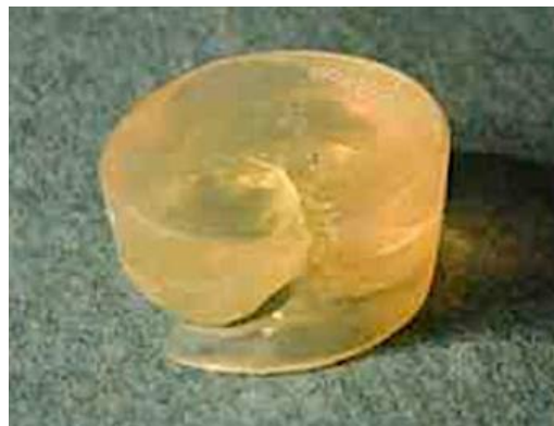
Figure 11 Fracture d'un implant de Swanson [6]
