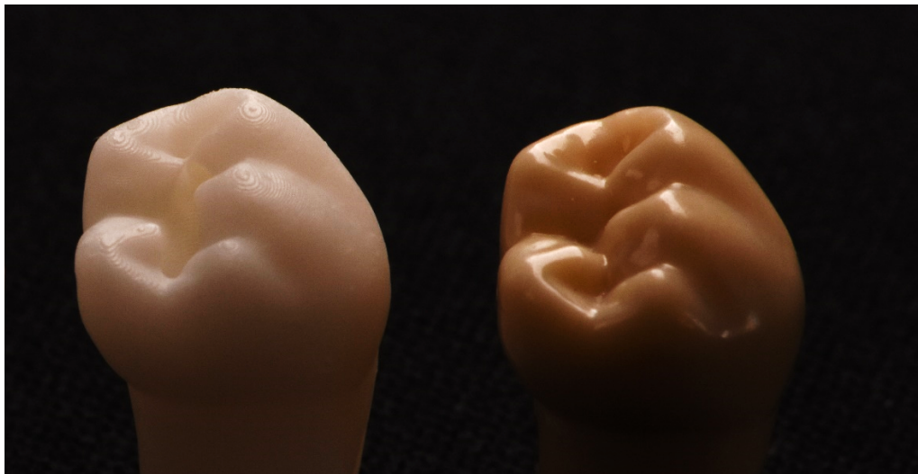
Figure 31 : Macrophotographie du modèle pédagogique ICDAS 4 imprimé avec une précision de 50 \mu m (à gauche) et modèle en résine injectée Frasaco® (à droite).
