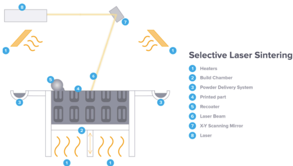
Figure 21 : Fonctionnement de la technologie SLS (28)
