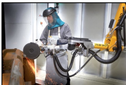
Fig. 62 : Ce cobot permet à un ouvrier d'une fonderie de travailler une imposante pièce métallique à l'aide d'une meuleuse d'angles sans avoir à supporter la masse de son outil, il peut ainsi se concentrer uniquement sur son geste et son adresse technique.
