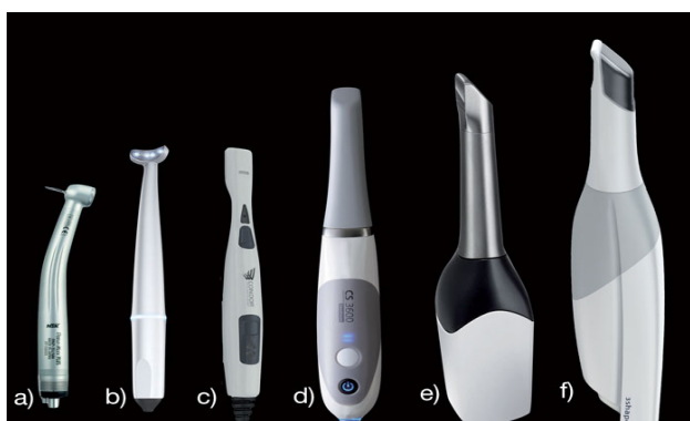
Figure 9 Comparaison des tailles de différentes caméras d'empreintes optiques par rapport à une turbine dentaire : a) Turbine, b)DWIO, c)CondorScan, d)CS3600, e) Omnicam, f) Trios 3 (Arcaute et Nasr 2017).
