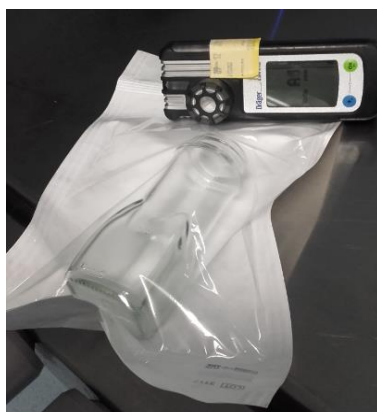
Figure 30 : Mesure sur le simple emballage TYVEK®
