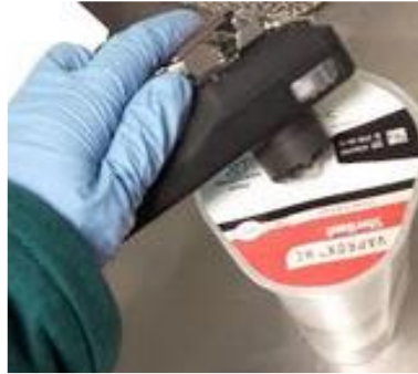
Figure 21 : Mesure à la surface de la cartouche percütée
