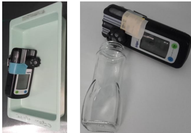
Figure 38 : Mesure sur plateau et à l'intérieur d'un DM creux
