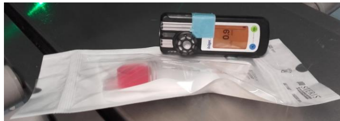
Figure 31 : Mesure à la surface du double emballage TYVEK® contenant un DM
