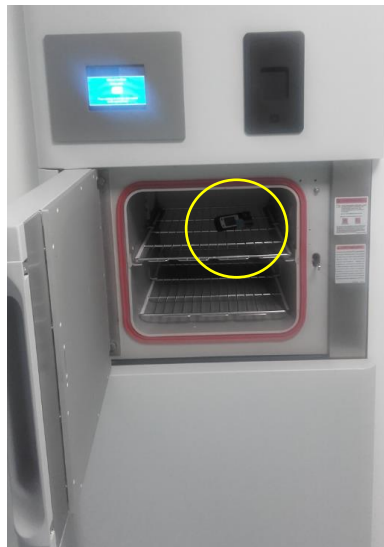
Figure 40 : Mesure à l'intérieur de la cuve vide (V-Pro Max)
