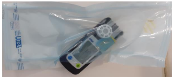
Figure 34 : Mesure à l'intérieur d'un sachet vide (ULTRA®)
