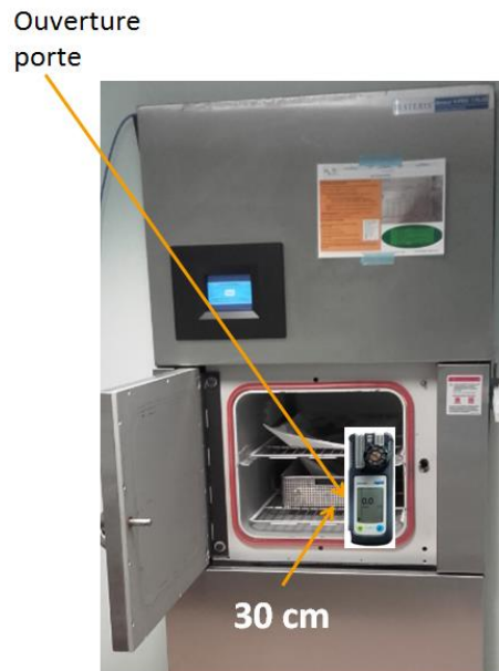
Figure 35: Mesure à l'ouverture de la porte
