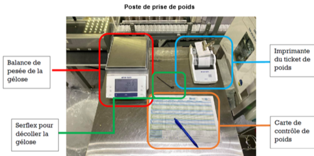
Figure 3: Poste de contrôle des poids pour les IPC
