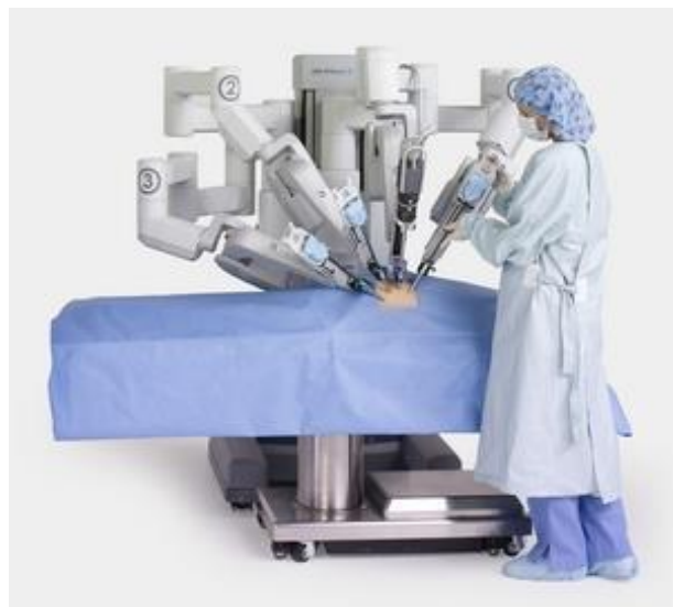
Figure 6 : Chariot patient du robot da Vinci®
