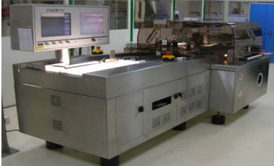
Figure 14 : Vue générale d'une mireuse électronique EISAI®
