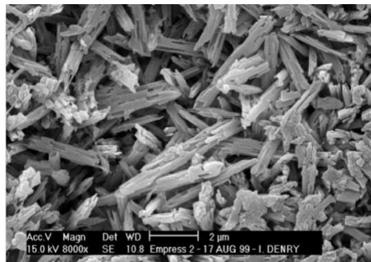
Figure 10 : Microstructure d'une vitrocéramique enrichie au disilicate de lithium (Kelly JR, 1997)
