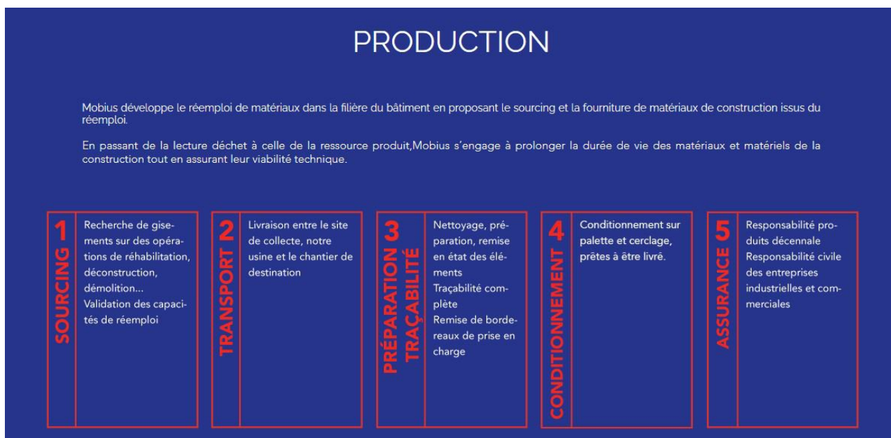
Figure 17 : Étapes de la filière de faux-planchers proposée par Mobius. Source : Site internet de Mobius
