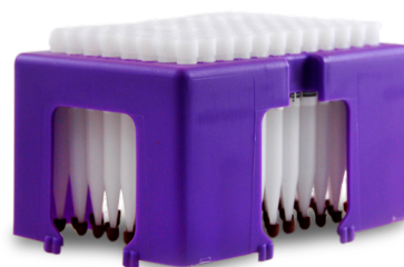
Figure 5 : Dispositif de micro-échantillonnage volumétrique par absorption VAMS (Neoteryx®) et son rack de 96 puits : Mitra® 96-Autorack
