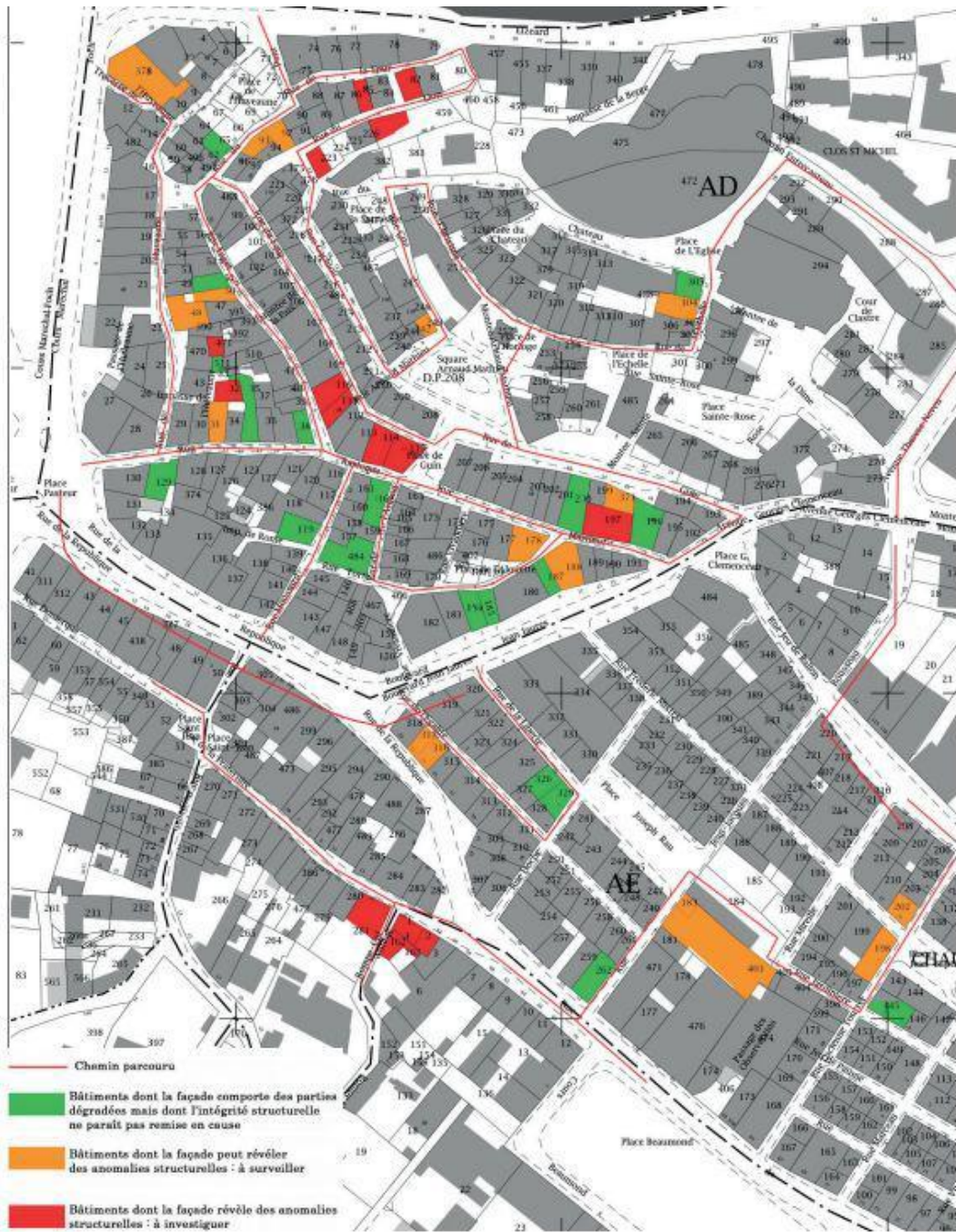
Figure 5 : Plan de repérage de l'Etat des bâtiments dans le centre ancien d'Aubagne (Source : Rassine Architecture)
